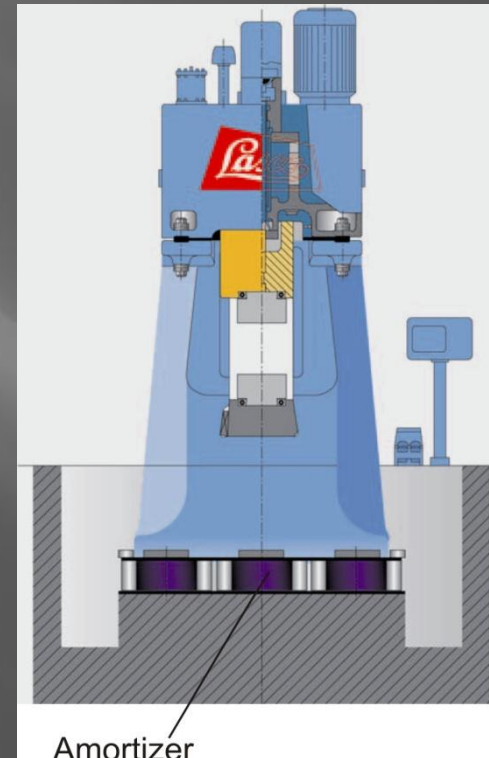
Slika 12.39 Amortizeri za smanjenje vibracija a) brzohoda presa Yamada Dobby [65], b) čekić, Lasko [60]
