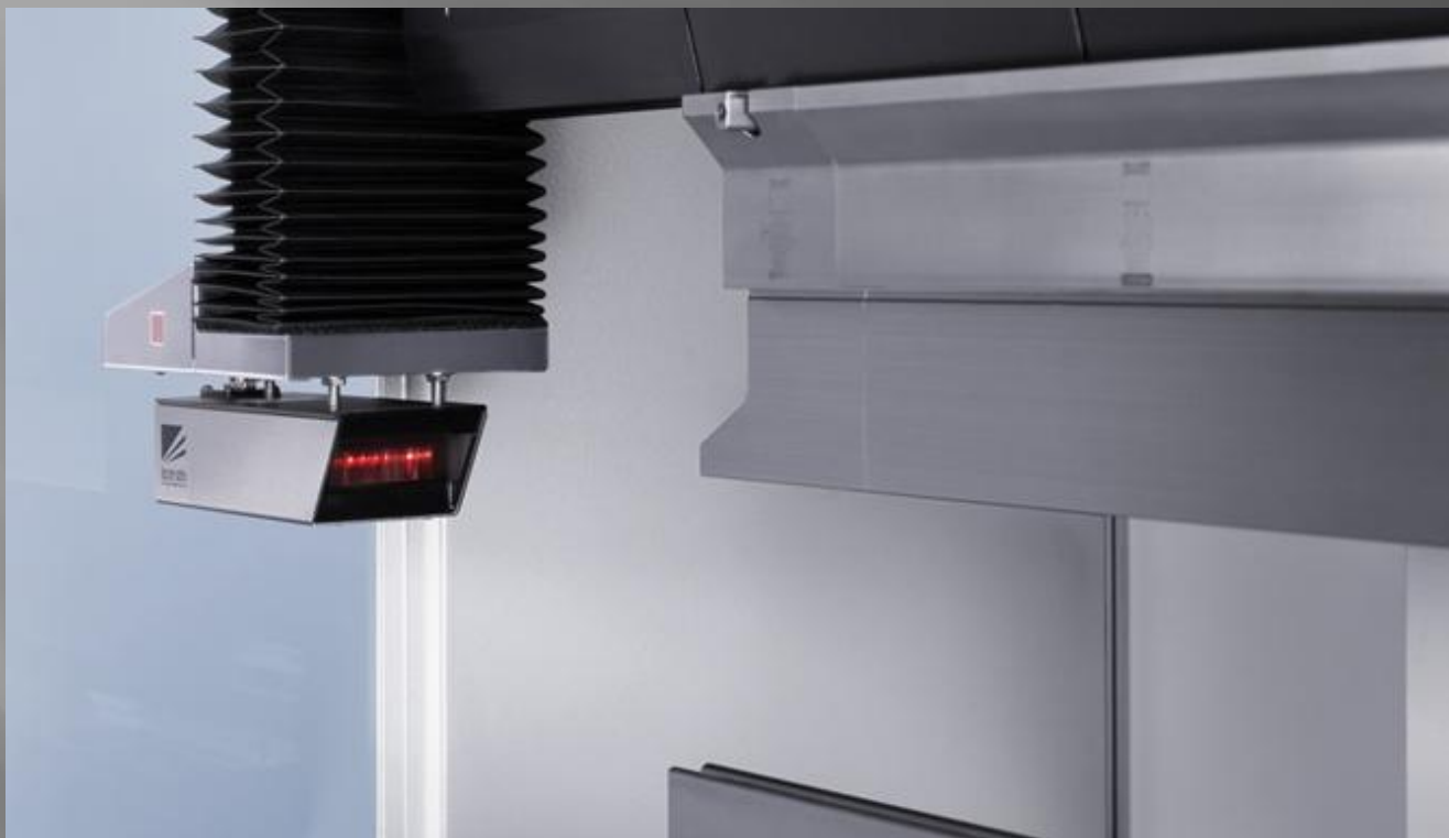
Slika 12.22 Laserska zaštita na apkant presi, Trumpf [67]
