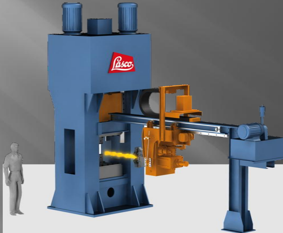
Slika 12.40 Posluživanje čekića programabilnim manipulatorom [60]
