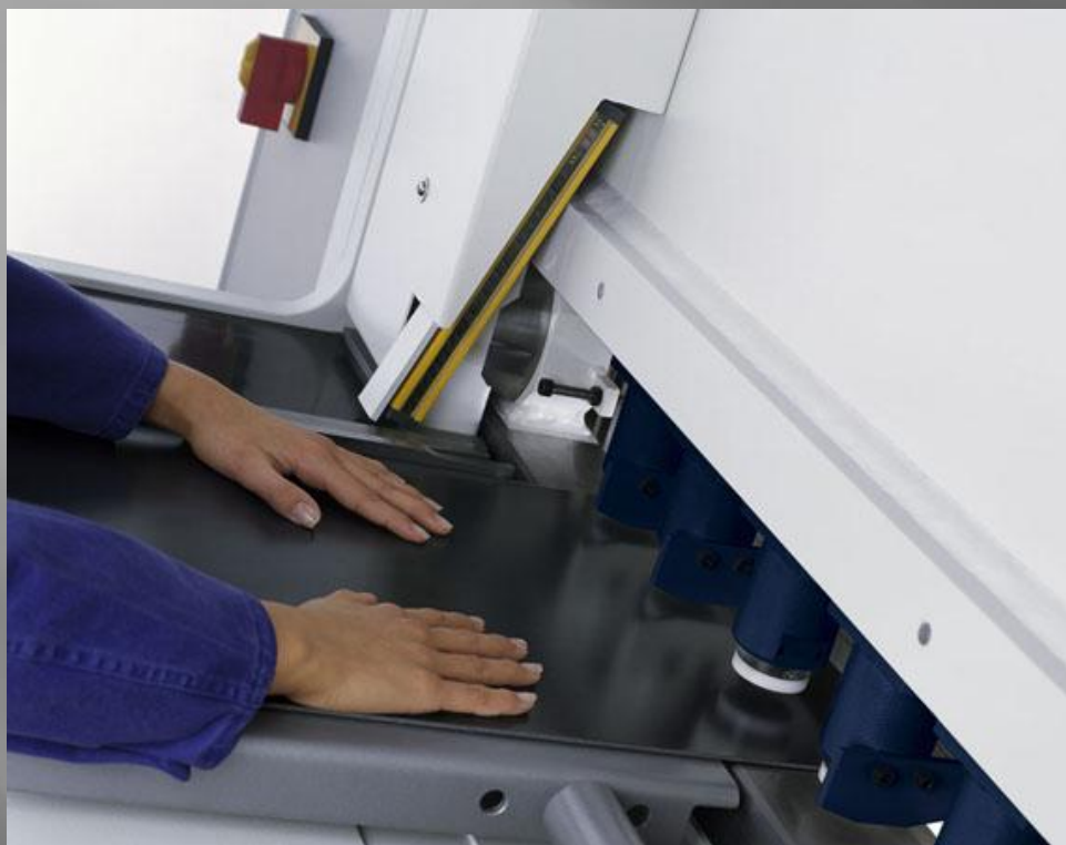
Slika 12.18 Svetlosna zaštita na makazama s pravim noževima, Trumpf [67]
