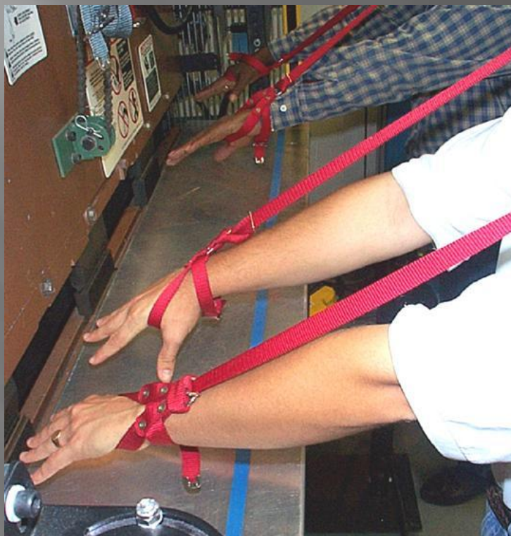
Slika 12.24 Sistem zaštite „pullback“ na apkant presi sa dva operatera [42]
