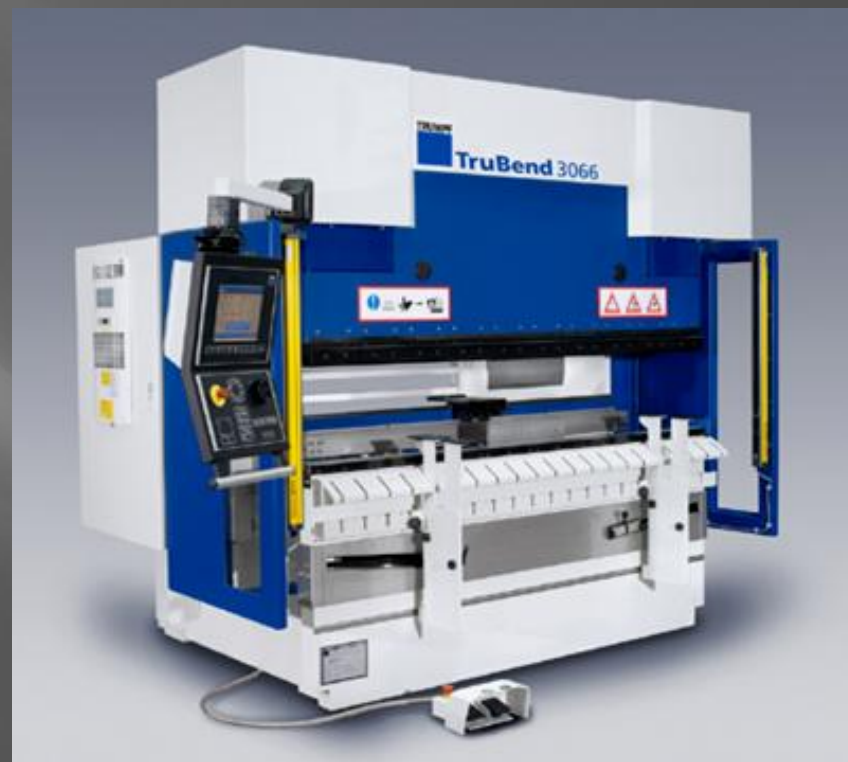
Slika 12.19 Svetlosna zavesa na apkant presi Trumpf [67]
